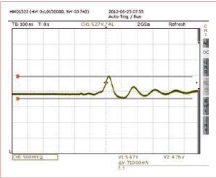
Bild 6. Verlauf der Ausgangsspannung bei impulsförmiger Laständerung.
