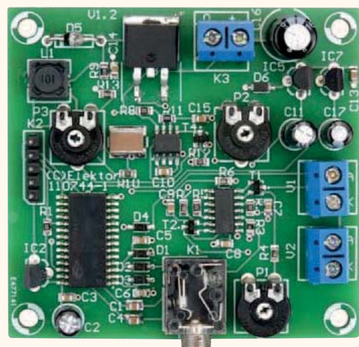
Bild 7. Die vom Elektor-Labor entwickelte Platine ist für eine gemischte Bestückung mit bedrahteten Bauteilen und SMDs gemacht.
